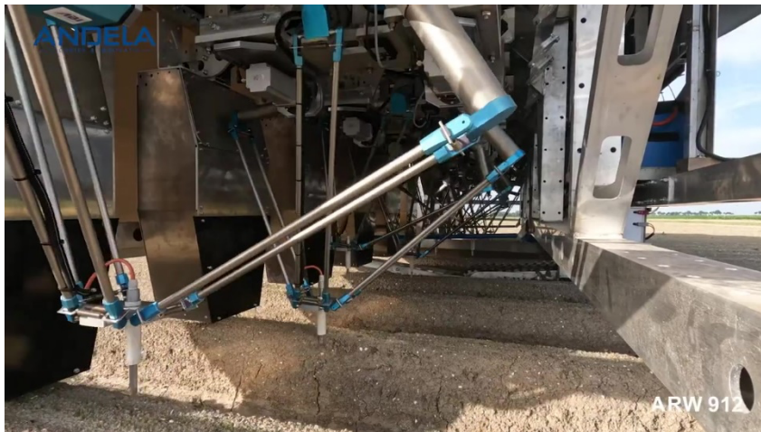
Fig. 2. Delta arms and end effector of Andela Techniek & Innovatie 1 robotic weeding machine. (Photo credits: Andela Techniek & Innovatie)
